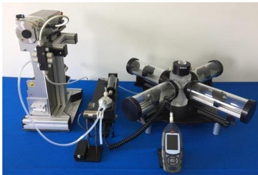
inExpose 與乾粉發成器的結合，精確控制乾粉的曝露
